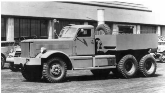
Diamond-T Model 981. Herkenbaar aan de kabeldoorvoer in de voorbumper.
