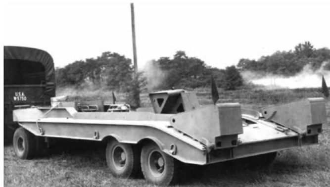
M9 prototype. Dat is te zien aan de drie "D-ringen" (bevestigingslussen) aan de zijkant van de aanhanger. Productieversies hebben vijf ringen.
