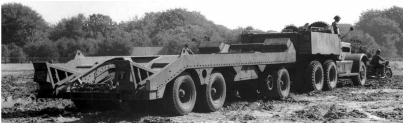
M20 met een Crane, 40t. Hier is goed de opstaande rand aan de zijkant van de aanhanger te zien. Hierdoor is hij herkenbaar als een Mk.I aanhanger.
