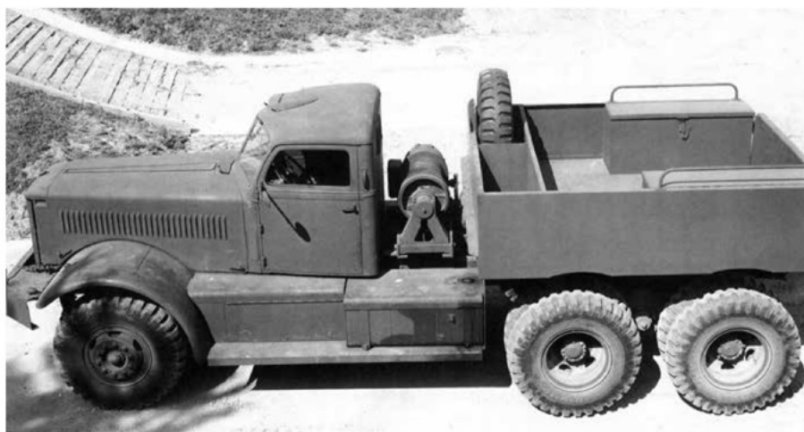
Model 980. Dit is de vroege productieserie. Hij had de lierbediening nog in de cabine.
